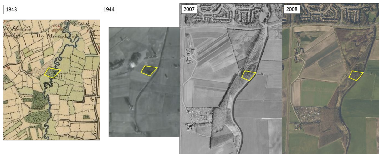
Figuur 3-5: Chronologie van het Molenbeekbos. Het oude bosrelict te midden van beemden (1843), met rechtgetrokken Watermolenbeek (1944), aangeplant omliggend bos en diepe watergang in het westen (2007) en de vispassage daartussen (2008).
